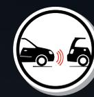
Les capteurs détectent si votre Durango s'approche trop rapidement d'un autre véhicule. Ils émettent des alertes sonores et visuelles à l'intention du conducteur et exercent une pression active sur les freins si le conducteur ne réagit pas à temps.
