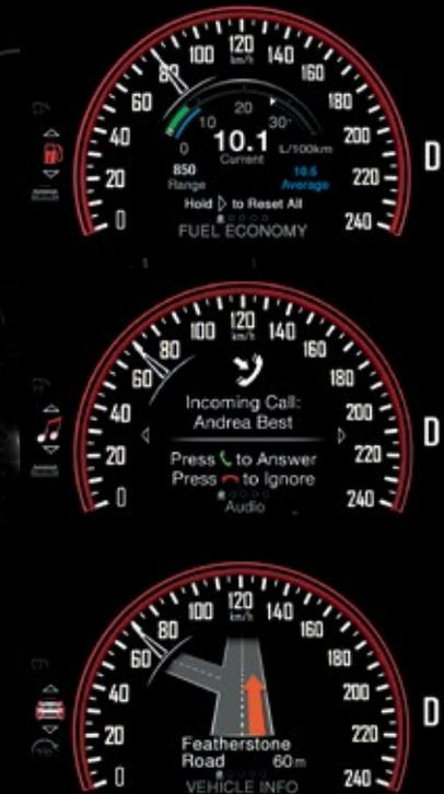
Les boutons de série sur le dessus du volant vous permettent de contrôler l'écran couleur configurable de 7 po intégré au groupe d'instruments. Vous pouvez alors voir des données de performance en temps réel, les états du véhicule et la navigation livrable en option<sup>13</sup>.
