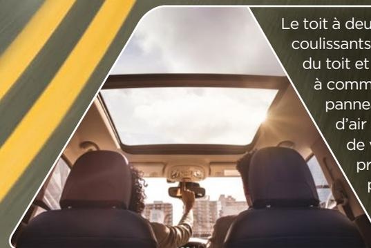
Le toit à deux panneaux de verre coulissants occupe toute la largeur du toit et comprend un pare-soleil à commande électrique, un panneau de verre avec entrées d'air à l'avant et un panneau de verre fixe à l'arrière. La protection antipincement permet d'éviter les blessures aux mains et aux doigts. Livrable en option.
